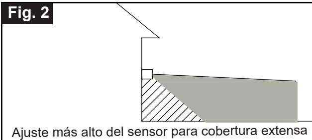
Ajuste más alto del sensor para cobertura extensa
